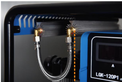
压缩空气冷却装置
